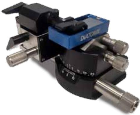
Ein Substrat wird an das ASH2 geklemmt und in die Messerwanne geführt. Durch Ablassen des Wasserspiegels nach erfolgtem Schneiden senken sich die Schnittbänder auf das Substrat ab und bleiben dort haften.
