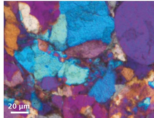
*Polarisationskontrast: Farbliche Darstellung der kristallografischen Orientierung der verschiedenen Phasen*
