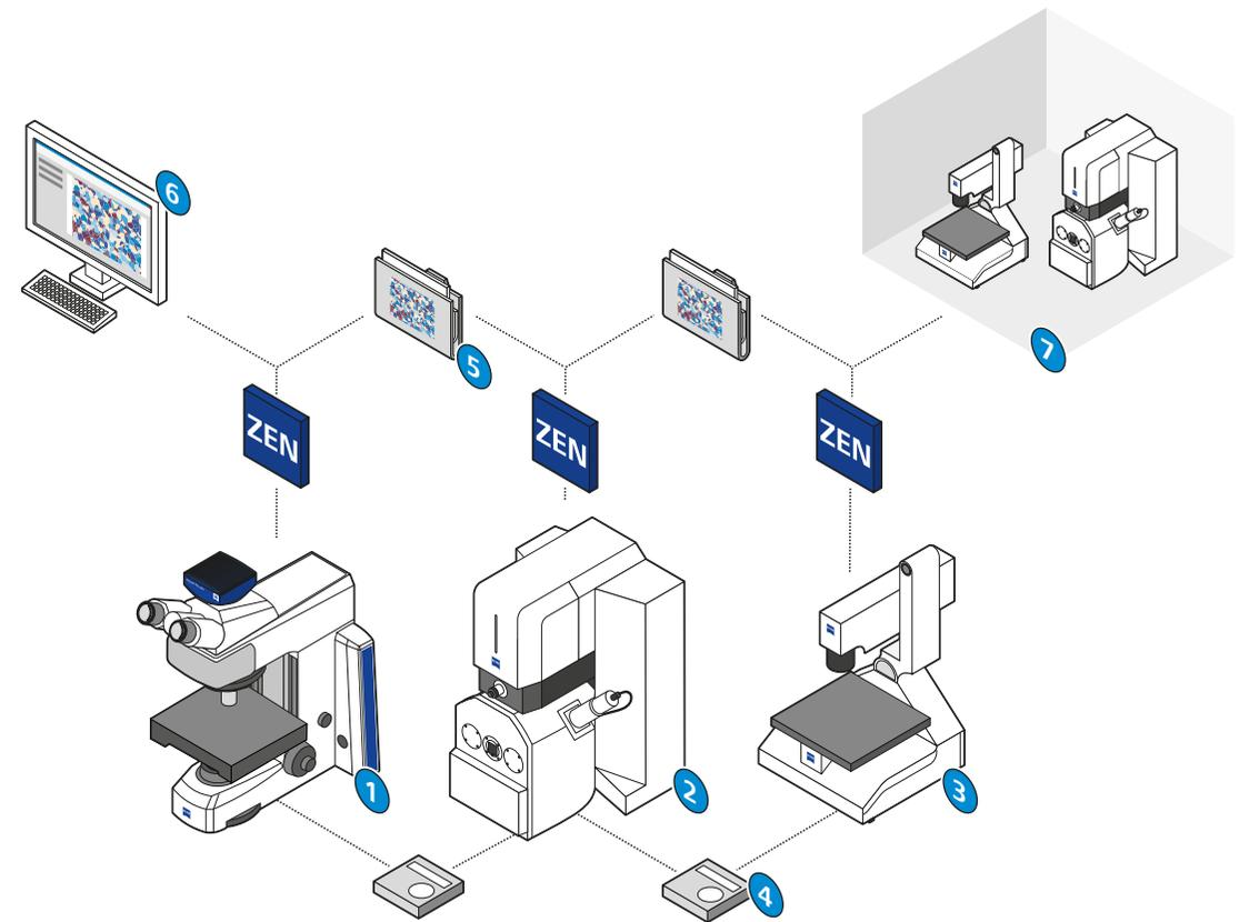
*Schema einer vernetzten Laborumgebung mit Axioscope (1), Elektronenmikroskop ZEISS EVO (2) und Digitalmikroskop ZEISS Smartzoom 5 (3). Im Rahmen eines multimodalen Workflows wird die zu untersuchende Probe von Mikroskop zu Mikroskop weitergegeben (4). Die Software ZEN 2 core (5) sorgt für einen konsistenten Datenaustausch zwischen allen beteiligten Geräten, separaten Analysearbeitsplätzen (6) und weiteren Laborstandorten (7).*
