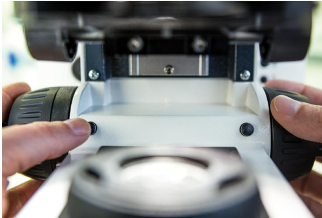
*Axioscope 5: beidseitig angeordneter Bildaufnahmeknopf
