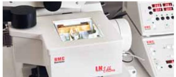
Die effiziente Nutzung des Flüssigstickstoffs (LN2) sorgt für eine stabile Schneideumgebung von bis zu 6 Stunden bei gleichzeitiger Senkung der Verbrauchskosten.
