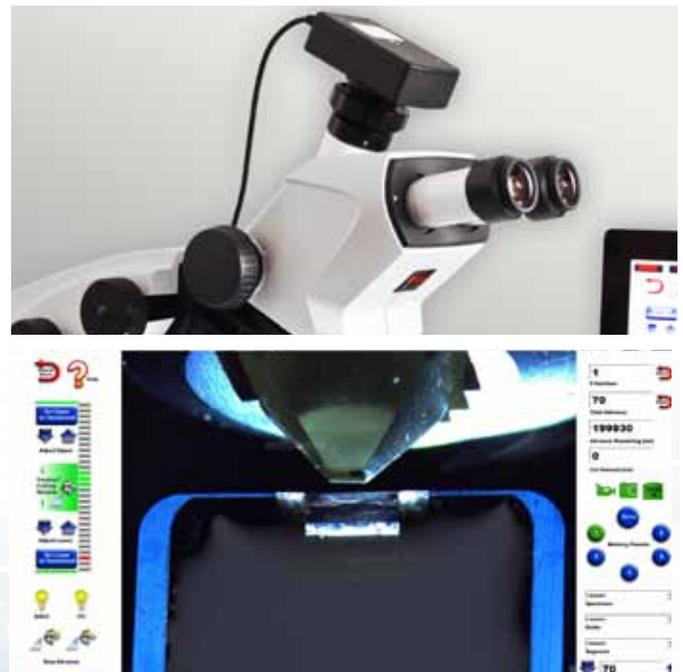
Über das HD-Videopaket wird der Schneidevorgang in Echtzeit in der Mitte des PC-Monitors dargestellt. Das integrierte Bilderfassungssystem ermöglicht die Aufnahme von Videos oder Standbildern für den Datenaus-
